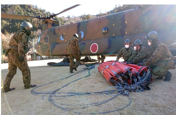
奥多摩町において消火機材の取り付け作業をする1施大
